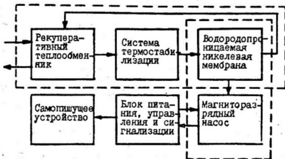
Рис. 4.5. Структурная схема индикатора водорода для контроля герметичности парогенераторов натрий—вода [39]
